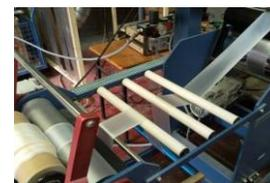
Extrusion d'électrolyte polymère gélifié
