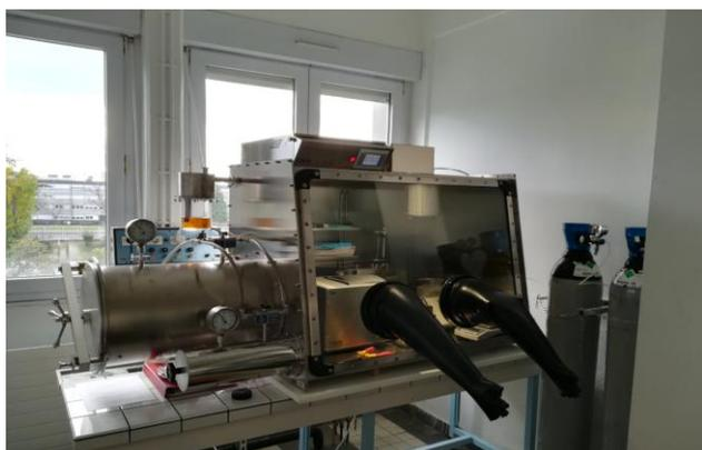
Depuis 2020, le laboratoire a mis en service une micro-extrudeuse sous boîte à gants pour la réalisation de mélanges polymères, sels ou céramiques, en atmosphère contrôlée.
